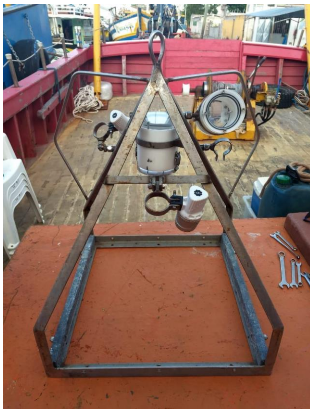
Figura 1: Foto da estrutura metálica (dropcâmera).
